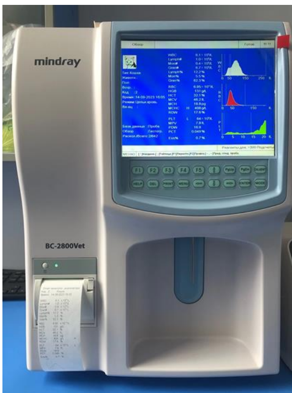
Рисунок 2 – Гематологический анализатор Mindray BC-2800 Vet (Китай)
